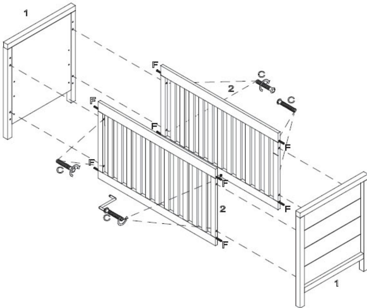
**Stap 1 :** Gebruik beide onderstellen 1, beide zijkanten 2, acht houten deugels F, acht verbindingsbouten C en de zeskantsleutel Z
