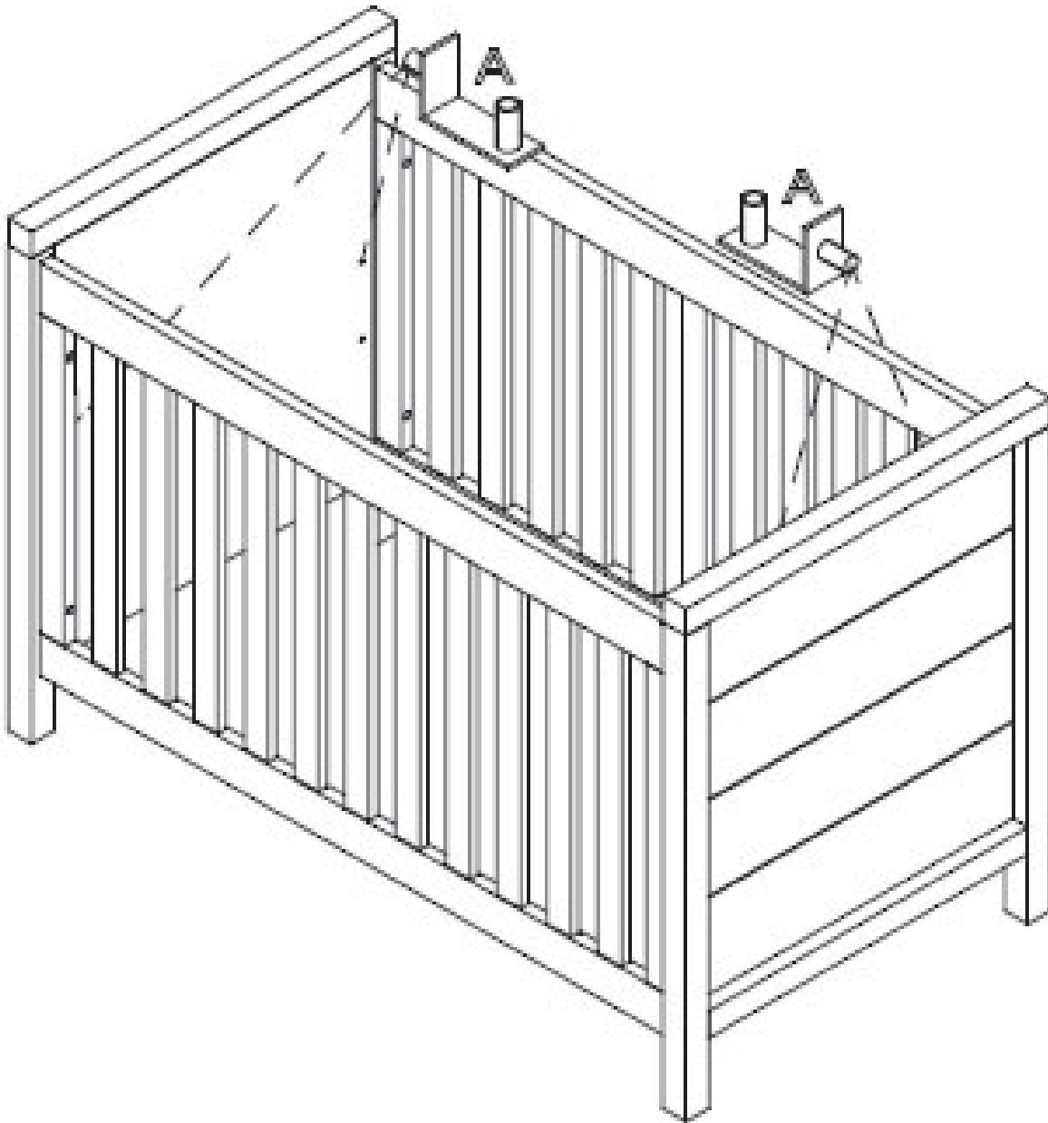
**Schritt 2 : Benutzen Sie die montierte Unterteile aus vorhergehender Schritte 1 und vier Bodenträger A**
