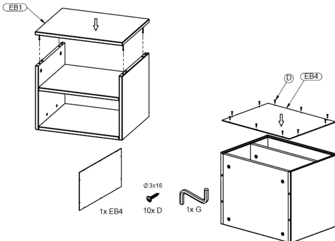
**Etape 7 :** Utilisez les pièces de l'étape 3 et 6, le dos EB4 et dix vis à bois D
