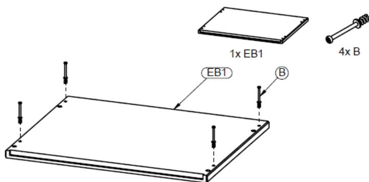
**Stap 3 :** Gebruik het bovenblad **EB1** en vier verbindingbouten **B**
