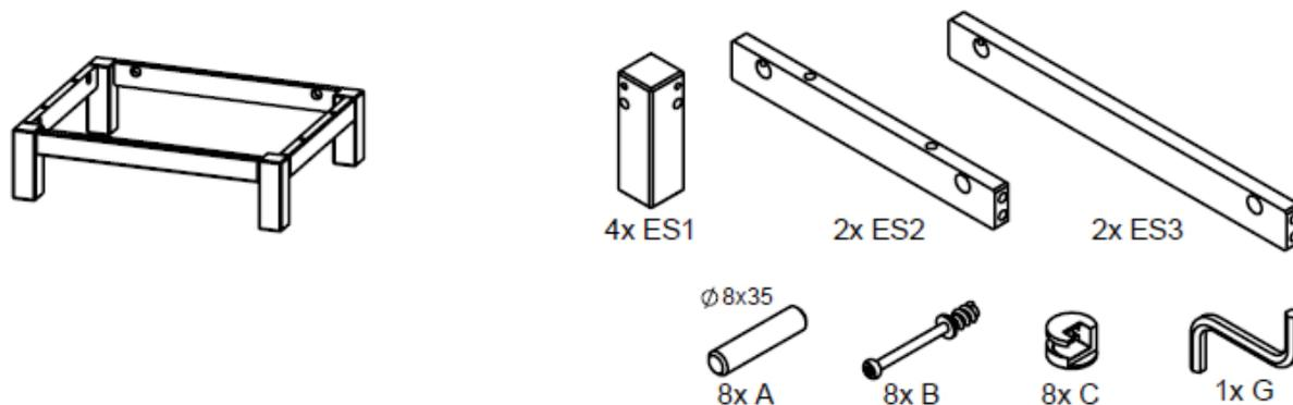
**Etape 1 :** Utilisez les deux traverses longues **ES3**, les deux traverses courtes **ES2**, huit excentriques **C**, les quatre pieds **ES1**, huit boulons de raccord **B** et huit chevilles en bois **A**
