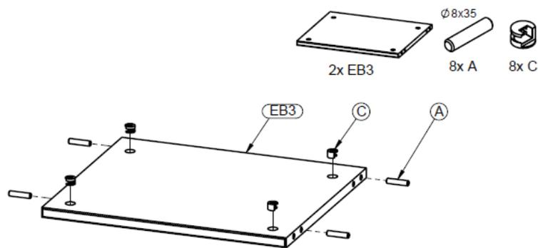
**Schritt 4 :** Benutzen Sie den Einlegeboden und den Boden **EB3**, acht Holzdübel **A** und acht Exzenter **C**
