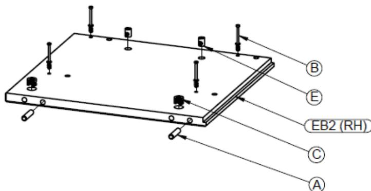
**Etape 5 :** Utiliser les deux côtés **EB2 LH** et **EB2 RH**, quatre chevilles en bois **A**, huit boulons de raccord **B**, quatre écrous **E** et quatre excentriques **C**
