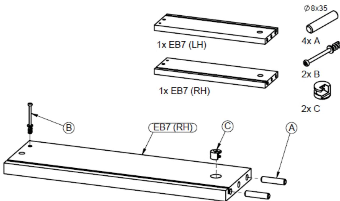
**Stap 11 :** Gebruik de linkse ladezijde **EB7 LH** en de rechtse **EB7 RH**, vier houten drevels **A**, twee verbindingsbouten **B** en twee excentrieken **C**
