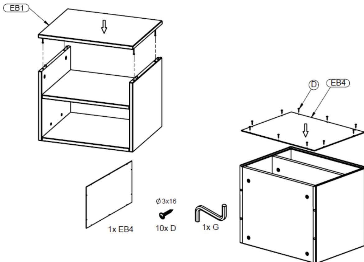
**Schritt 7 :** Benutzen Sie die Bauteile von Schritt 3 und 6, den Rücken EB4 und zehn Holzschrauben D
