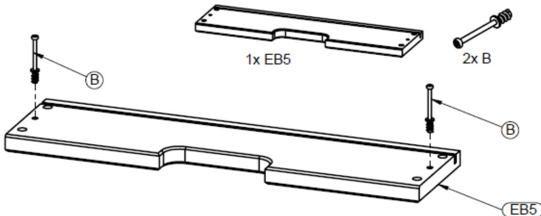
**Stap 9 :** Gebruik het ladefront EB5 en twee verbindingbouten B
