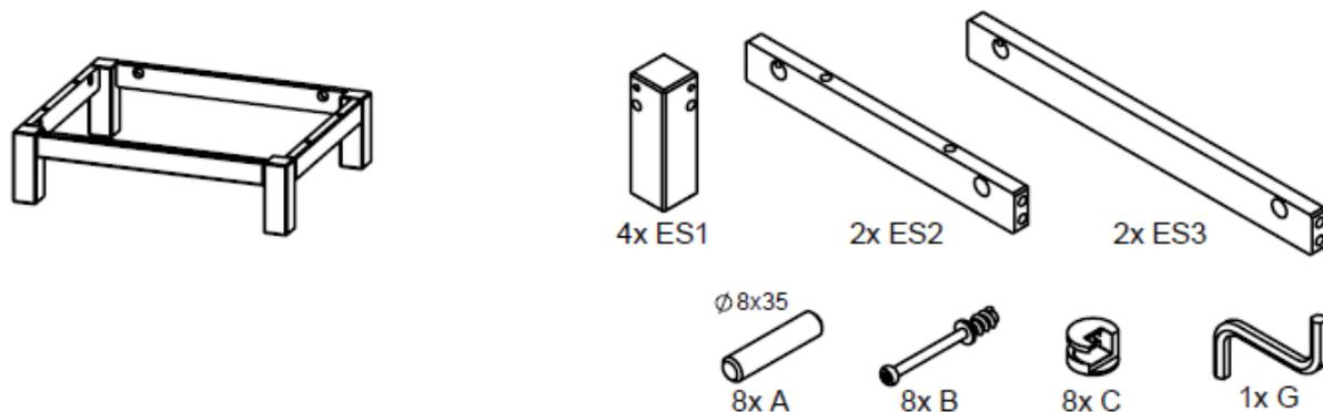
**Stap 1 :** Gebruik beide lange dwarsbalken **ES3**, beide korte dwarsbalken **ES2**, acht excentrieken **C**, de vier poten **ES1**, acht verbindingbouten **B** en acht houten drevels **A**.
