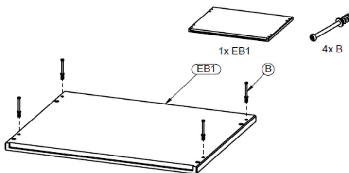
**Etape 3 :** Utilisez le plateau **EB1** et quatre boulons de raccord **B**
