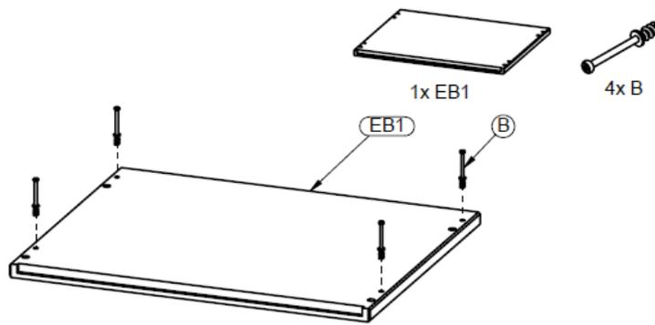
**Schritt 3 :** Benutzen Sie die Oberplatte **EB1** und vier Verbindungbolzen **B**
