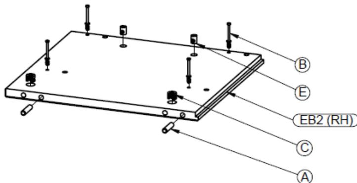
**Schritt 5 :** Benutzen Sie beide Seiten **EB2 LH** und **EB2 RH**, vier Holzdübel **A**, acht Verbindungsbolzen **B**, vier Muttern **E** und vier Exzenter **C**
