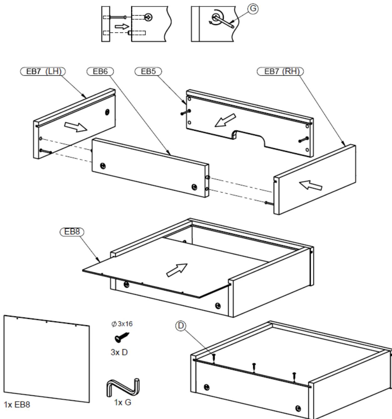
**Schritt 12** : Benutzen Sie die Bauteile von Schritt 10 bis 13, den Schubladeboden **EB8** and 3 Holzschrauben **D**
