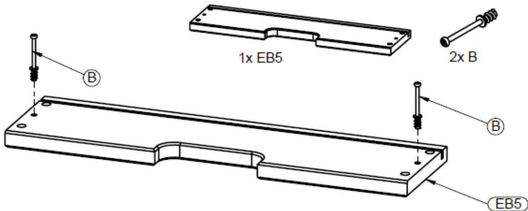
**Etape 9 :** Utilisez le front de tiroir **EB5** et deux boulons de raccord **B**
