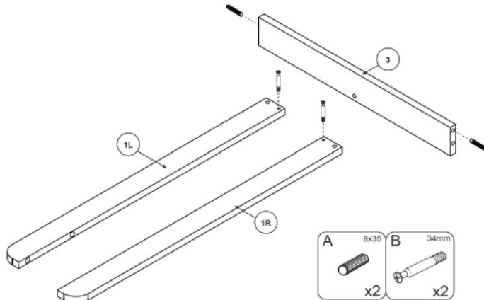
**Etape 1 :** Utilisez les côtés **1L** et **1R**, le dos **3**, deux chevilles en bois **A** et deux boulons de raccord **B**
