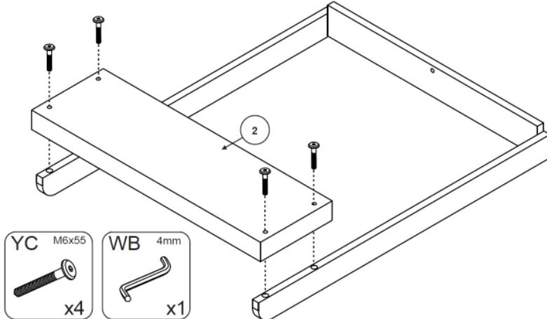
**Etape 3 :** Utilisez les pièces de l'étape 2, la plaque de fond 2, quatre vis à bois YC et la clé hexagonale WB
