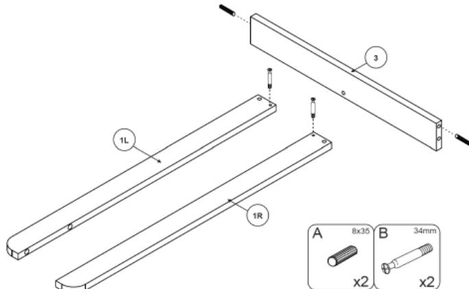
**Schritt 1 :** Benutzen Sie die Seiten **1L** und **2R**, den Rücken **3**, zwei Holzdübel **A** und zwei Verbindungsbolzen **B**
