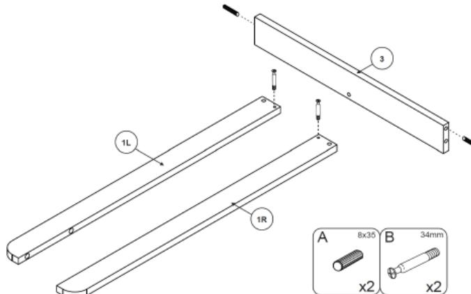
**Stap 1 :** Gebruik de zijden **1L** en **1R**, de rug **3**, de twee houten deugels **A** en twee verbindingsbouten **B**
