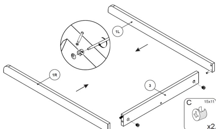
**Schritt 2 :** Benutzen Sie die Unterteile von Schritt 1 und zwei Verbindergehäuse **C**
