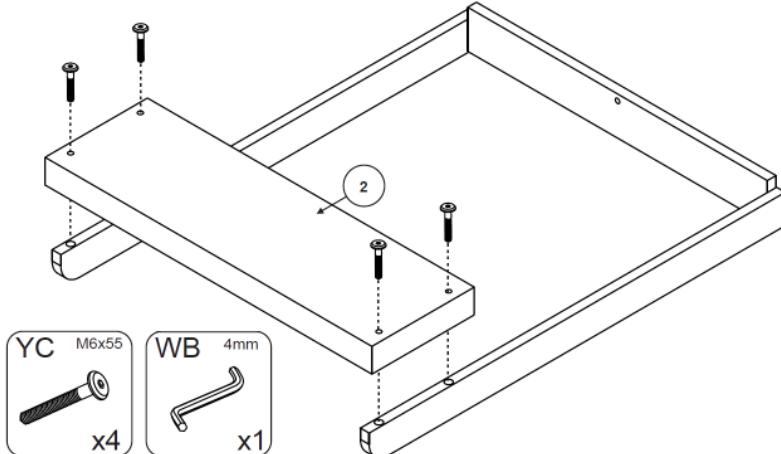
**Schritt 3 :** Benutzen Sie die Unterteile von Schritt 2, die Bodenleiste **2**, vier Holzschrauben **YC** und den Sechskantschlüssel **WB**
