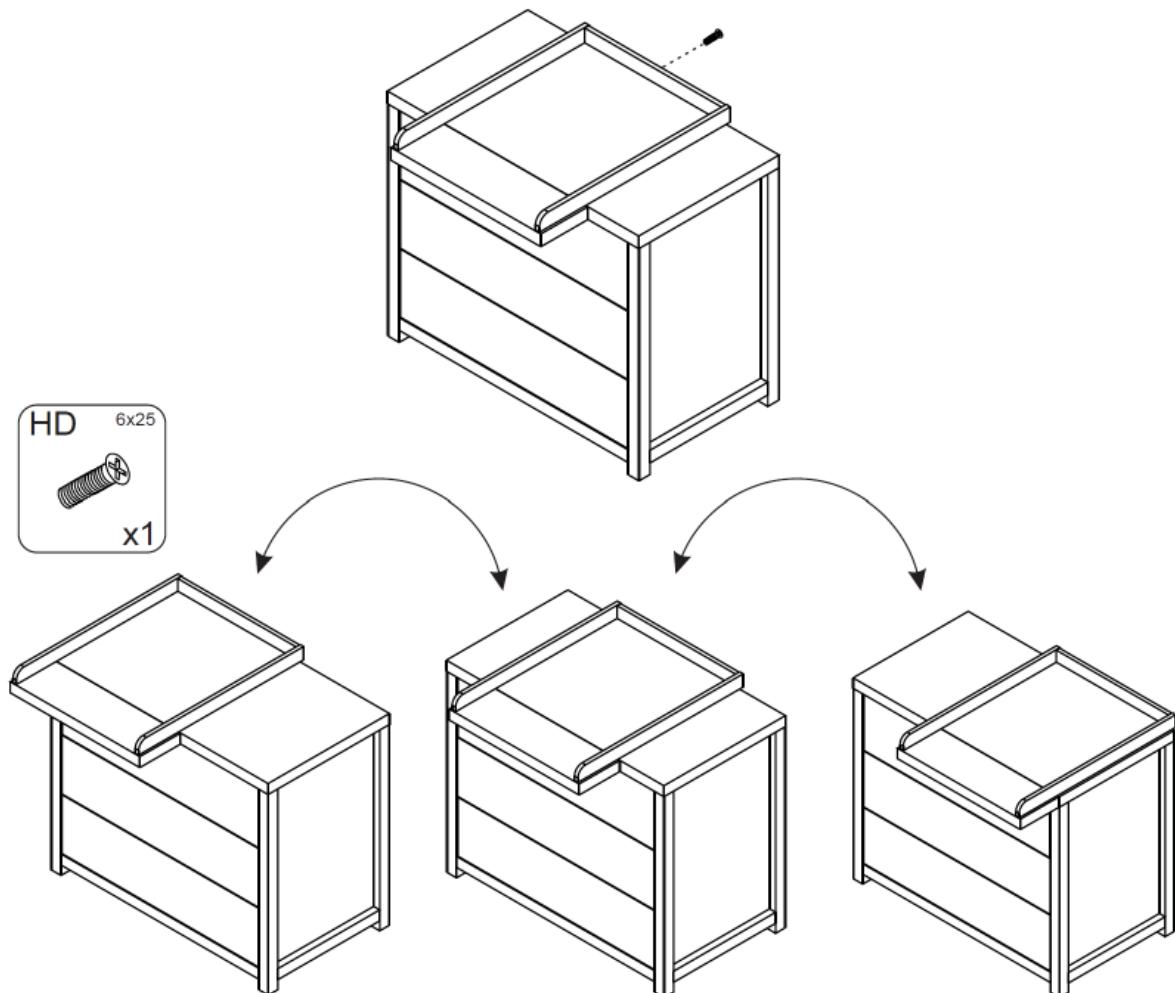
**Schritt 4 :** Benutzen Sie die Unterteile von Schritt 3, die Stripes Kommode und einer Bolzen **HD**
